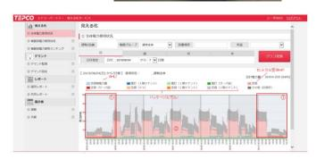
実際のエネマネ画面のイメージ(週報)になります。 [特徴] 土日の負荷が低い事が確認できます。また、 □空調(セントラル空冷 HP)の電力割合が高い事が 確認できます。
