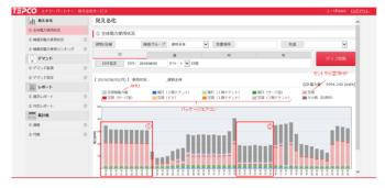
実際のエネマネ画面のイメージ (日報) になります。 [特徴] 蓄熱設備が導入されており、蓄熱運転が適性 に行われている夜間負荷が高い電力ロードカーブとな っています。また、ピークカット運転を行っています。
