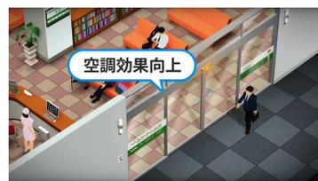
人の動きを読み取り、自動ドアを通行したい人にだけ開き(下図右)、横切るだけの人には開閉しません(下図左)。また、自動ドアを通行した方がドアを通過し終えたことを検知し速やかに閉じる機能も備えています。
